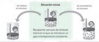
¿Qué sucederá con la presión del gas? Aumenta el número de choques entre las moléculas del gas y contra las paredes del recipiente. Por ende, la presión aumenta. ¿Qué sucederá con la presión del gas? Disminuye el número de choques entre las moléculas del gas y contra las paredes del recipiente. Por lo tanto, la presión disminuye.
